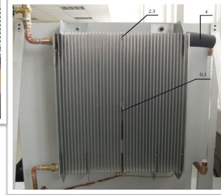
Experimentálne zariadenie tepelnej trubice s uzavretou slučkou.
