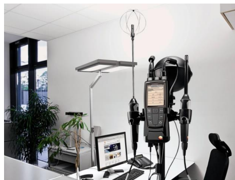
Obr. 4 Vľavo: Príklady typov konštrukcie termoanemometrických sond – drôtik, teliesko, guľôčka [1]. Vpravo: Multifunkčný prístroj Testo 480 pre meranie v technike prostredia. Umožňuje pripojiť celý rad sond, real-time výpočty a ukladanie dát [3]
