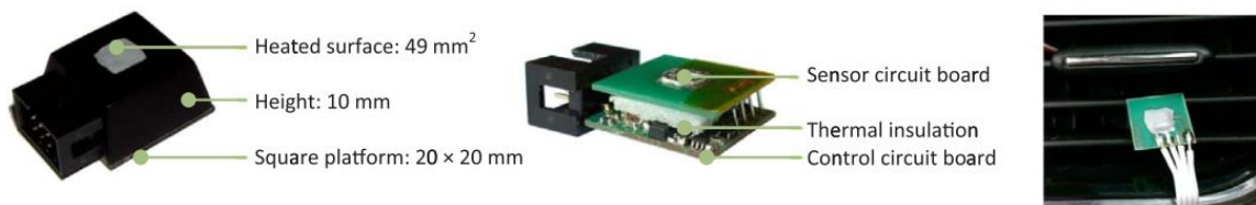
Obr. 14 Rozmery iHVAC senzora, pohľad na riadiaci a vyhrievaný prvok, aplikácia senzora do výustku HVAC systému auta, preložené z [2]
