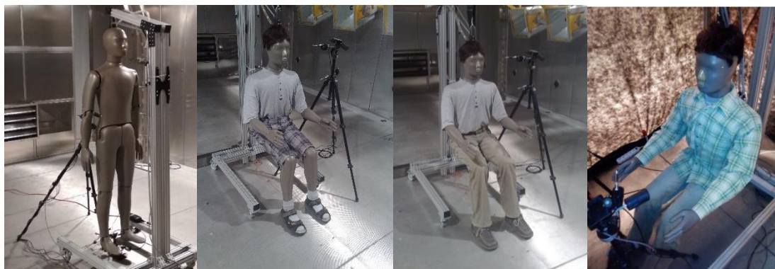
Obr. 24 Fotodokumentácia odevov k diagramom uvedeným na obr. 6.6. Zľava stojací manekýn (1 – bez odevu a vlasov), sediaci manekýn (2 – ľahký letný odev, 3 – letný odev, 4 – jesenný odev)
