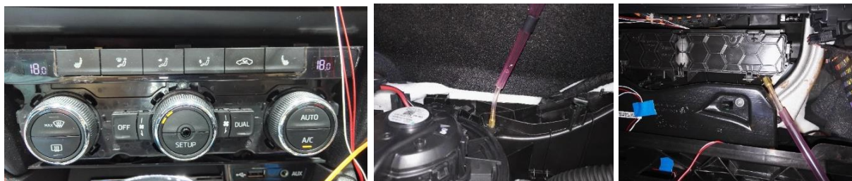
Obr. 11 Ovládací panel HVAC jednotky a tlakové odbery skrine HVAC jednotky
