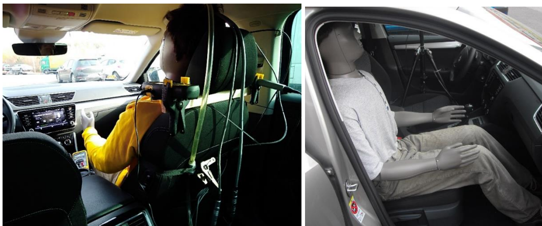
Obr. 26 Ukážka aplikácie tepelného manekýna, vľavo: zimný odev, konfigurácia s dýchacím aparátom; vpravo letný odev, základná konfigurácia
