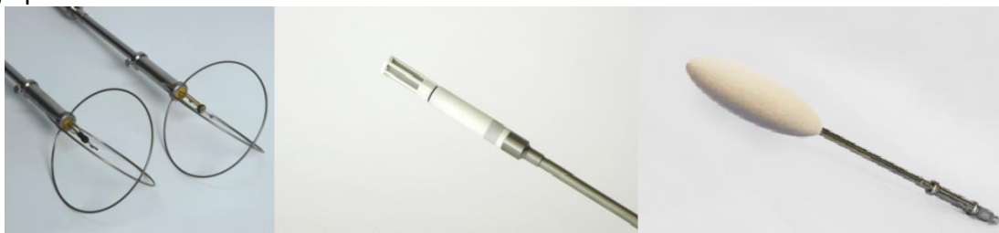
Obr. 37 Meracie členy pre meranie: teploty a rýchlosti prúdenia vzduchu (vľavo), relatívnej vlhkosti (vstrede) a strednej radiačnej teploty (vpravo)
