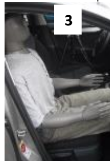
Obr. 22 Postup vyhodnotenia tep. komfortu pomocou tepelného manekýna
