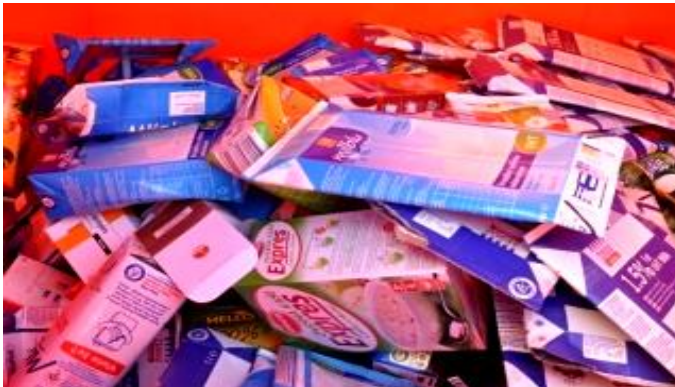
Obr. 3.1 Viacvrstvé kombinované materiály na báze lepenky.
