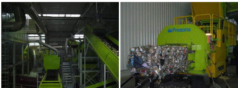
Obr. 11.8 Mechanická úprava (vľavo) a balíkovanie výhrevnej frakcie (vpravo).
