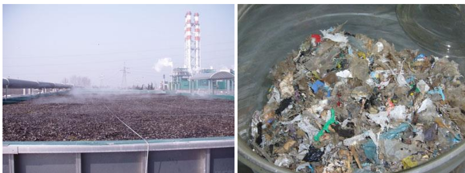
Obr. 11.11 Čistenie plynu (vľavo) a odpadné palivo (vpravo).
