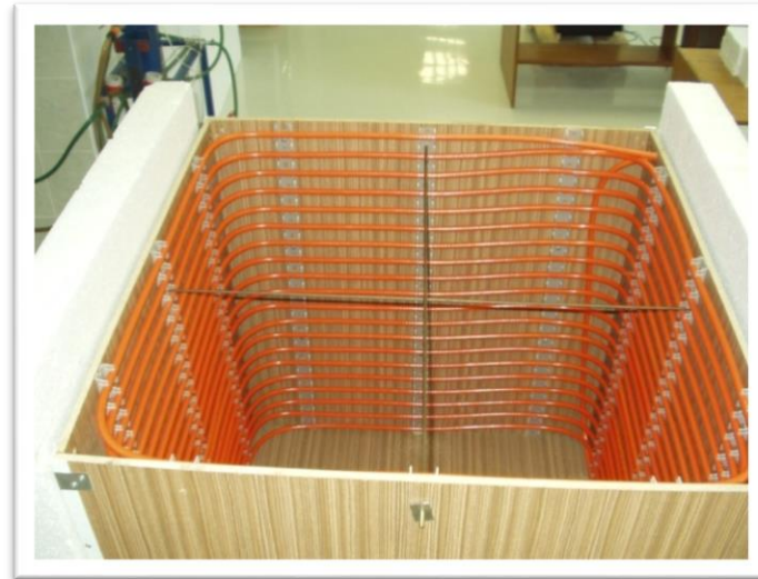
Termostatická komora pre testovanie chladenia prirodzenou konvekciou.
