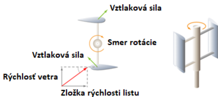
Obr.8.7 Schéma a princíp Darrieusovej turbíny (Svetenergie, 2021).
