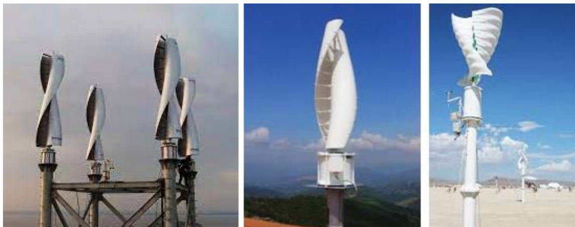
Obr. 8.6 Aplikácie Savoniusovej turbíny (Archiexpo, 2022; Link.springer, 2022; Nationalgeographic, 2022).
