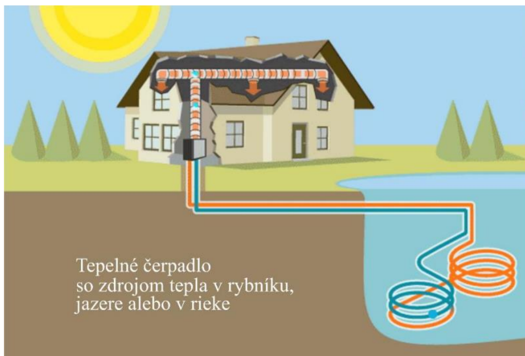
Obr. 6.11 Tepelné čerpadlo – zdroj tepla / voda (Čaja, 2020).
