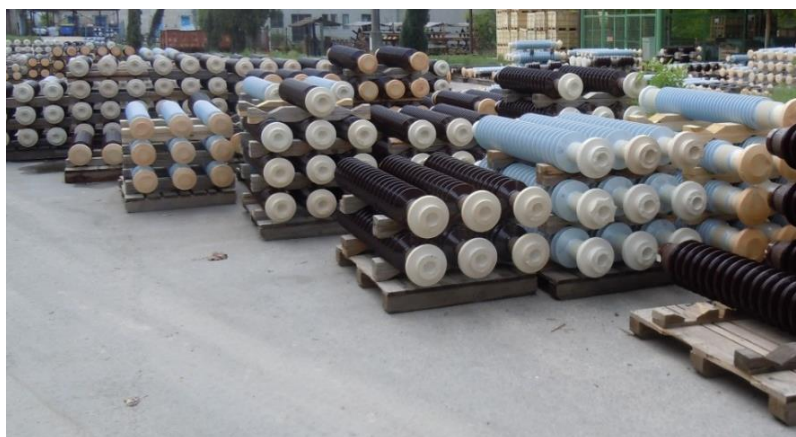
Obr. 11.39 Keramické izolátory pre elektrické stroje a vedenia (Malcho, 2018).
