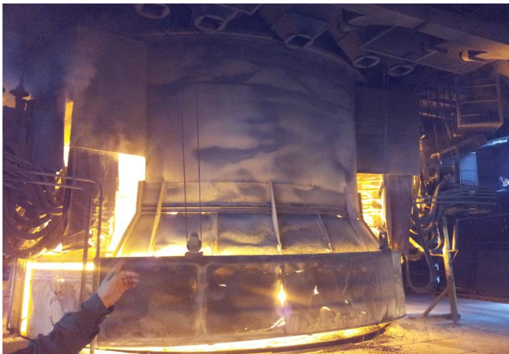
Obr. 11.34 Pôvodná konštrukcia klobúka pece pri výrobe ferozliatin (Malcho, 2018).
