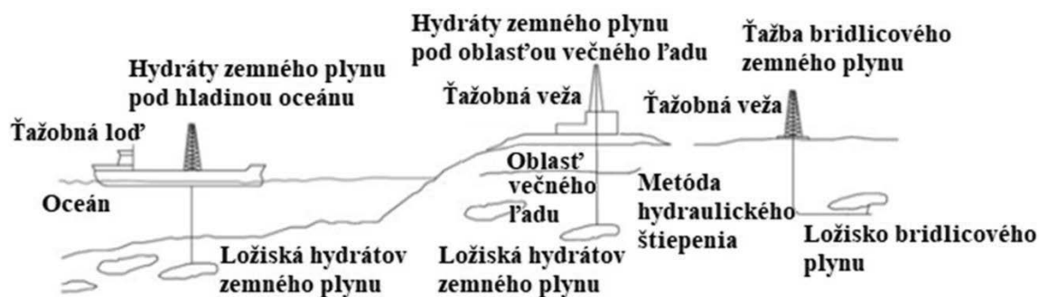
Obr. 11.20 Schematický náčrt lokalít ťažby hydrátov zemného plynu a ich porovnanie s ťažbou bridlicového plynu (Jaga group, 2016).
