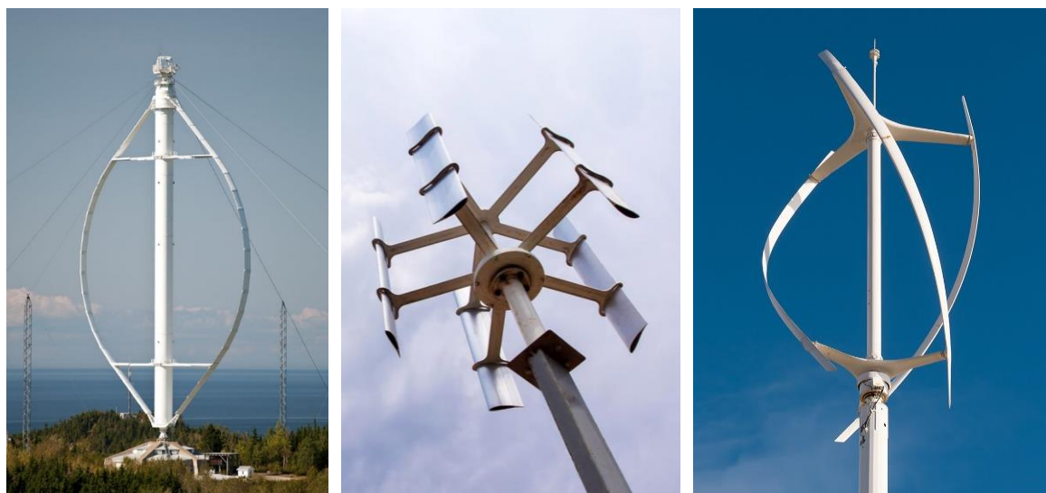
Obr. 8.9 Aplikácie Darrieusovej turbíny
