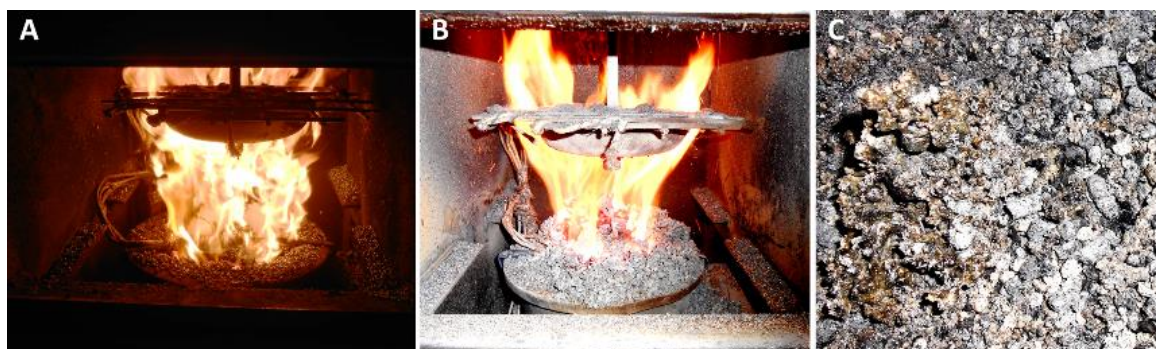
Obr. 9.25 Prevádzkové problémy spaľovania alternatívnych biopalív A-spaľovanie repky olejnej; B-spaľovanie peliet z pšeničnej slamy; C-vzniknuté spekančov popola (Jandačka, 2016).
