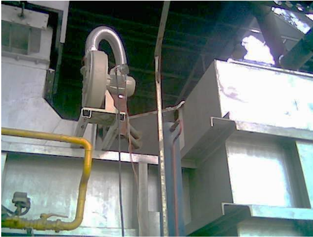
Obr. 11.25 Umiestnenie modelu výmenníka tepla v spalínovode taviaceho agregátu (Malcho, 2018).
