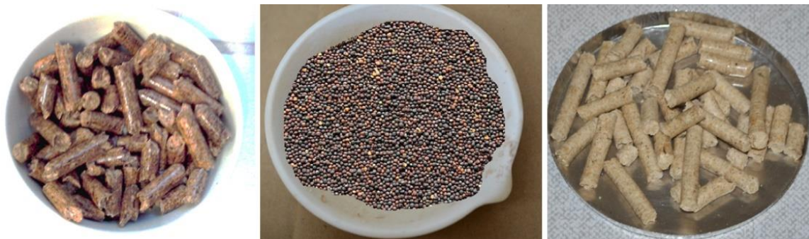
Obr. 9.23 Použité typy biopalív, zľava pelety vyrobené z pšeničnej slamy, semená repky olejnej, drevné pelety (Jandačka, 2016).
