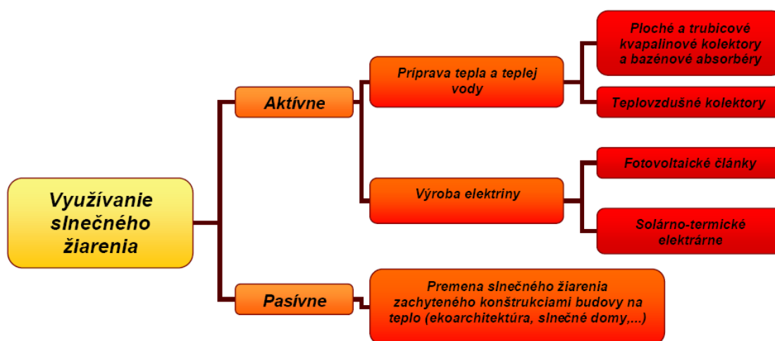
Obr. 10.3 Možnosti využívania slnečnej energie (Iliaš, 2006).
