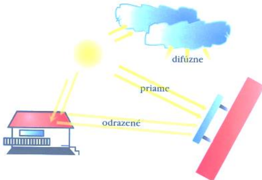
Obr. 10.2 Zložky slného žiarenia pri povrchu Zeme (Maderová, 1997).
