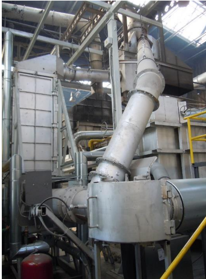
Obr. 11.31 Situovanie navrhnutého rekuperačného zariadenia v prevádzke (Malcho 2018).
