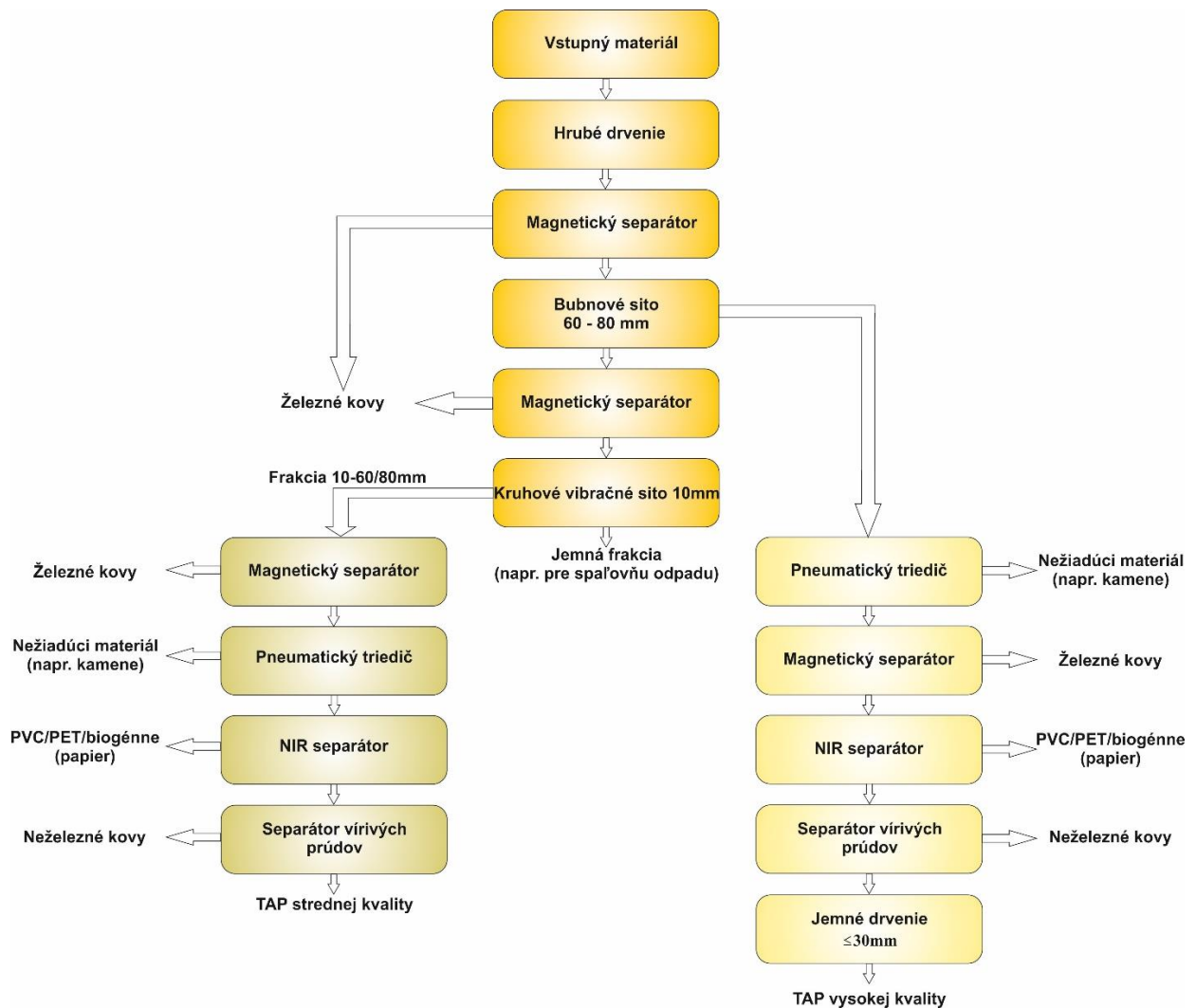
Obr. 2-6 Viacstupňová schéma spracovania prijatá v rakúskych čistiarniach na kombinovanú výrobu TAP strednej kvality (t. j. hrubého materiálu) a TAP prémiovej kvality (t. j. jemného materiálu)
