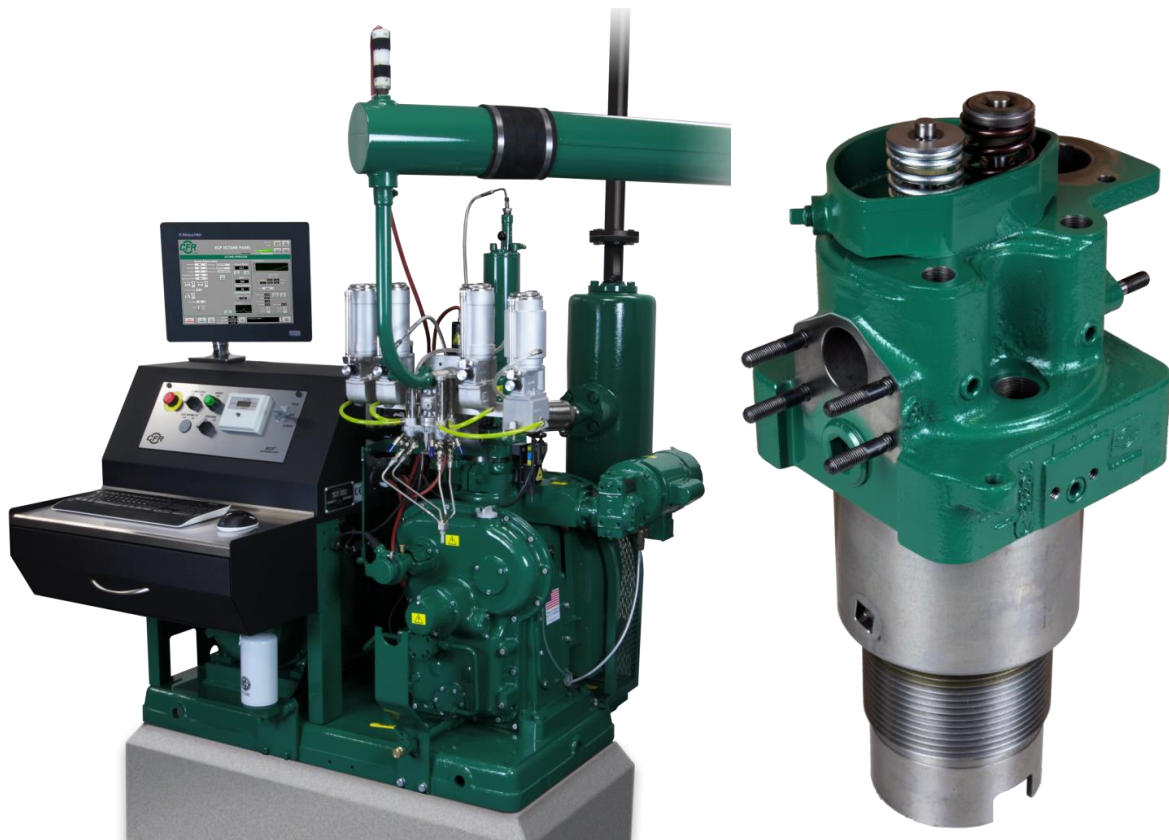
Obr. 3-18 Motor CFR pre stanovenie oktánového čísla výskumnou a motorovou metódou. [21]
