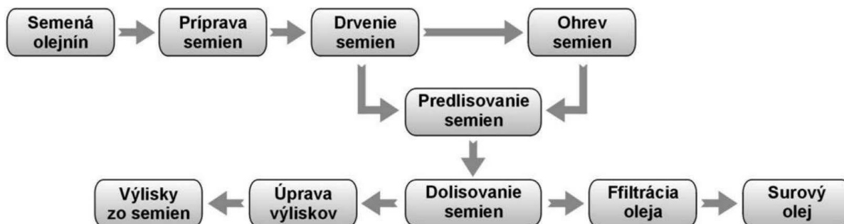
Obr. 3-23 Systém predlisovanie – dolisovanie
