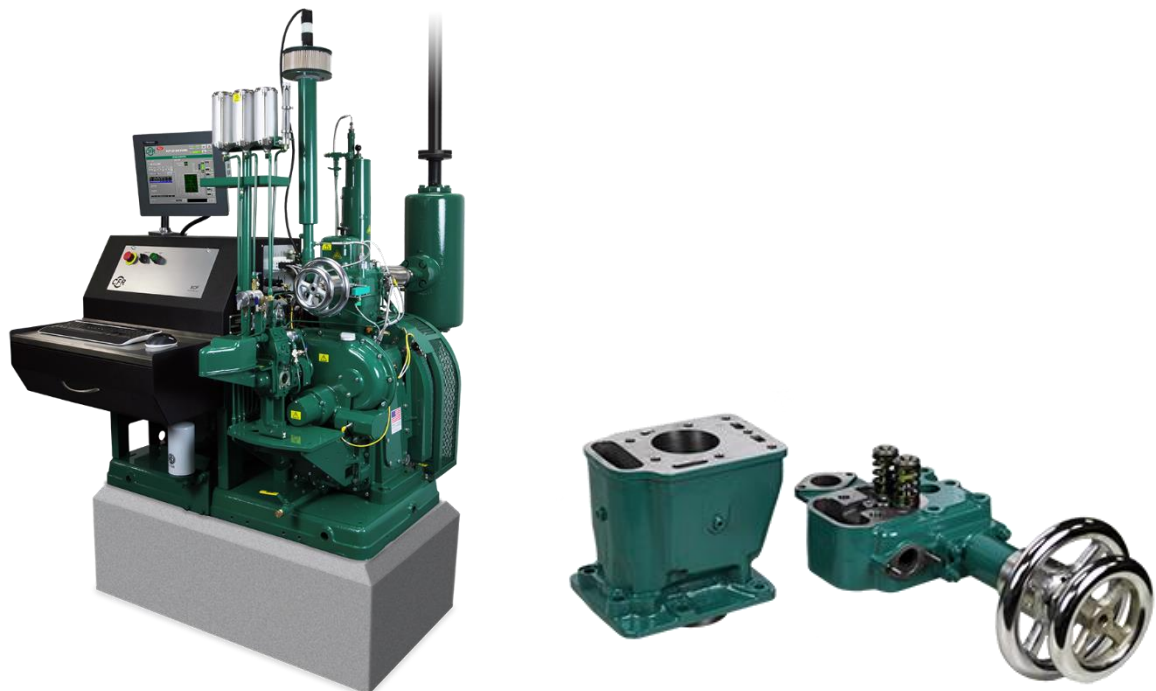
Obr. 3-19 Motor CFR pre stanovovanie cetánového čísla. [21]
