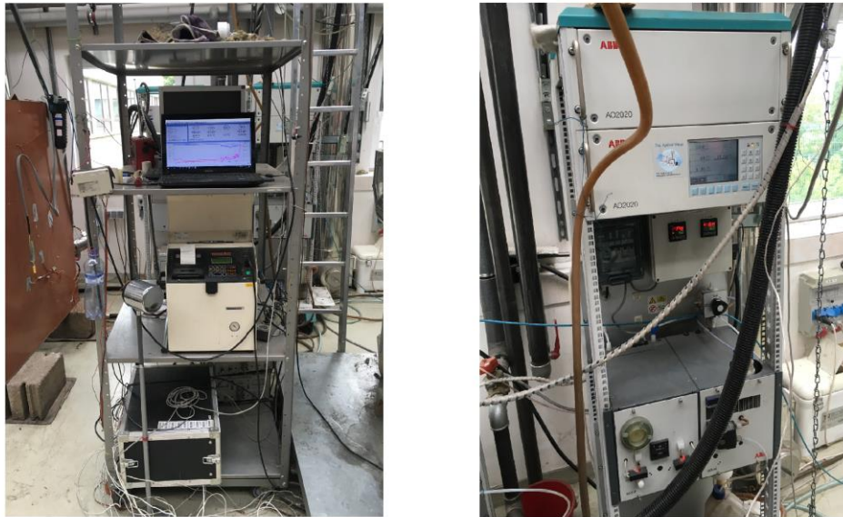
Obr. 184 Zariadenie na meranie TZL (vľavo) a emisií CO a NO x ABB AO 2020 (vpravo)
