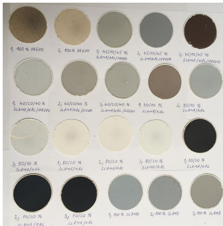
Obr. 25 Ukážky zanesenia filtrov po meraní TZL
